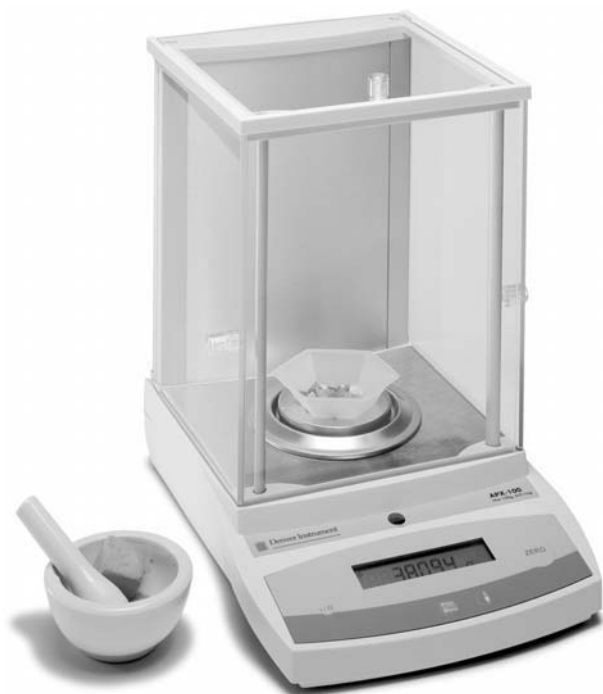
Figura 2.1. Balanza analítica electrónica. (Cortesía de Denver Instrument Co. Las imágenes son propiedad de Denver Instrument Company.)
