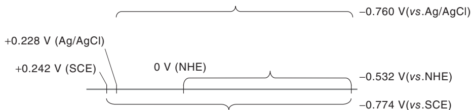
Figura 13.4. Representación esquemática del potencial de electrodo relativo a diferentes electrodos de referencia.
